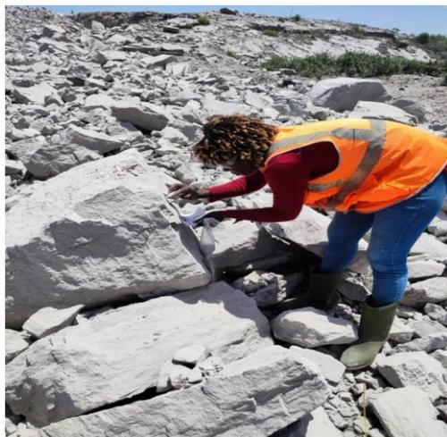
**Figure 4 :** *Échantillonnage de poussière sur les blocs après le dynamitage*
