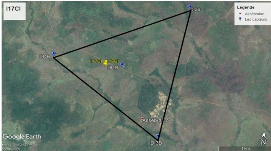
Figure 1 : Réseau micro-barométrique de la station I17CI en Côte d'Ivoire. Les micro-baromètres utilisés et leur localisation sont référencés par DI1B, DI2B, DI3B et DI4B. La distance entre les micro-baromètres est \sim 3 km
