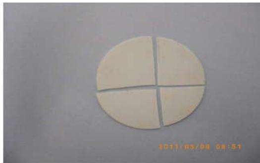
**Figure 2** : Échantillon de substrat d'alumine de 2 pouces (25,4 mm de diamètres), découpé en 4 autres échantillons
