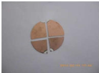
**Figure 4 : Échantillon après le dépôt de cuivre**
