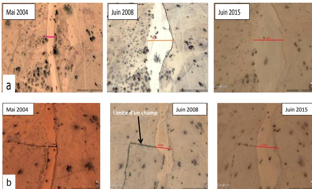
**Figure 9 :** Érosion par recul des berges dans les koriges 1 (a) et 2 (b) entre 2004 et 2015
