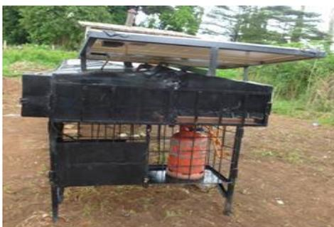
**Figure 1a :** Séchoir hybride vu d'un côté
