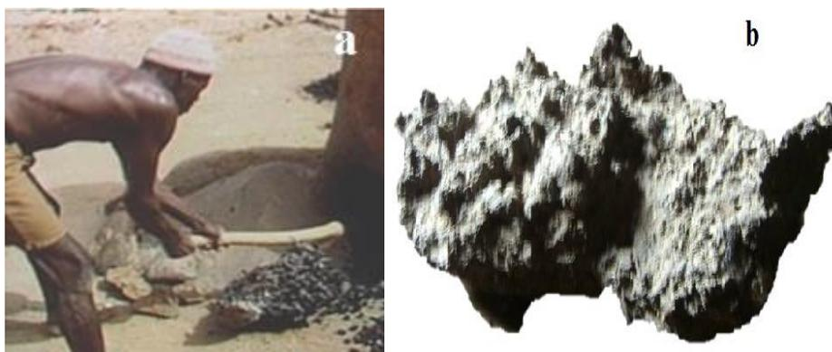
**Figure 3** : Extraction (a) et photo de la loupe de fer brut (b)
